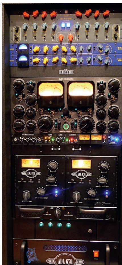
Rack 2: Der Chandler Curvebender (ganz oben) und ein modifizierter Shadow Hill (4. von oben), die Brauer im Master-Bus einsetzt.
