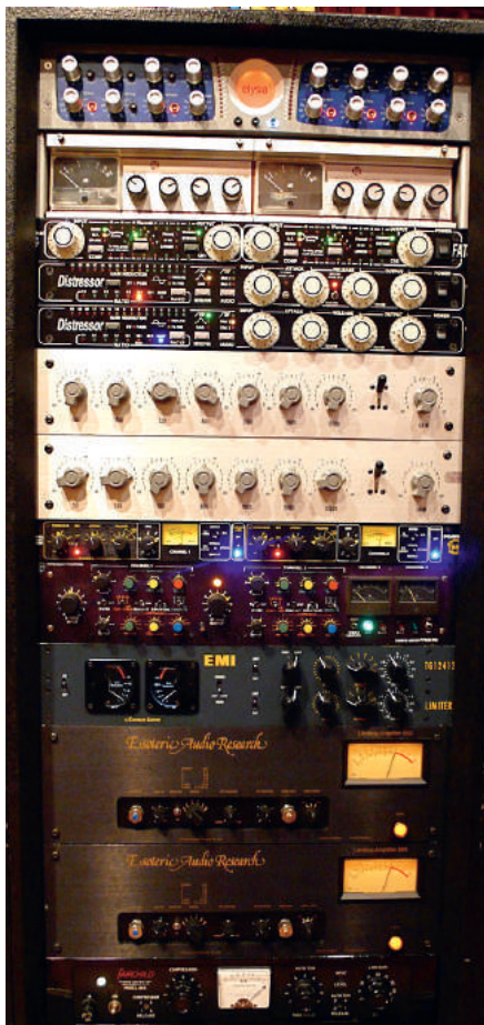
Rack 4: Birgt unter anderem die Empirical Labs Distressors (4. u. 5. v. oben), die sich in Brauers B-Bus (wie "Bottom") wieder finden.
