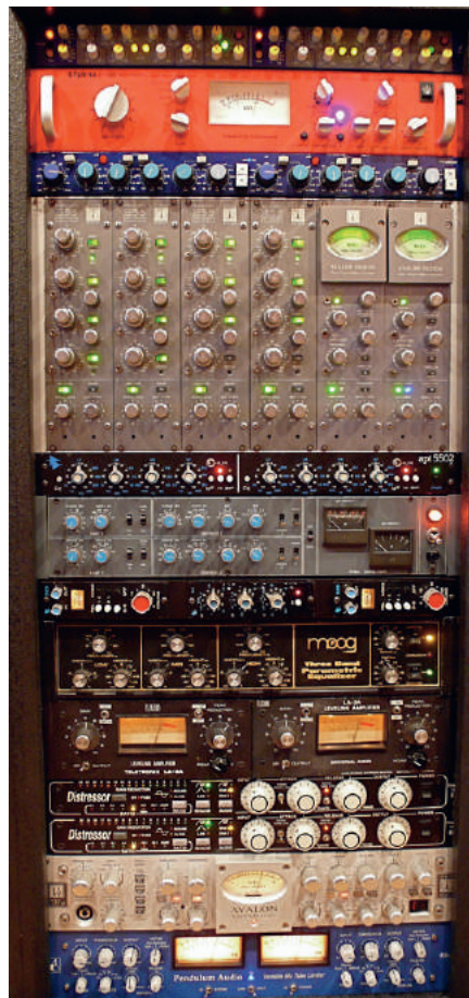
Rack 5: Zum Beispiel mit Neve 33609 (6. v. oben), den Brauer in den A-Bus seiner Technik schaltet, also für „All around“-Signale.
